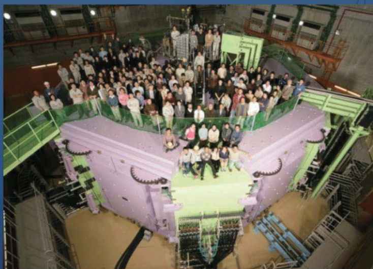
第9号、新造・超伝導リングサイクロトロン。 2006年12月稼働開始。8000トン
