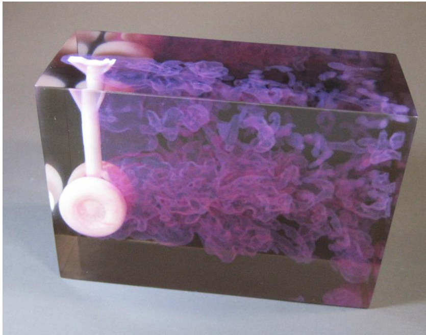
ランディングギアによる流れの乱れ
