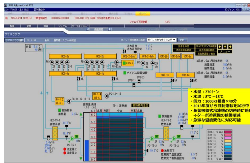
Figure 12 温度成層方式の蓄熱槽
