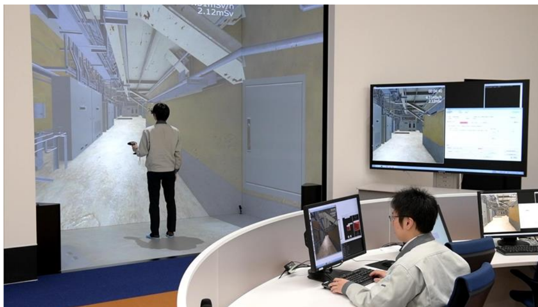
図 3. 1. 1-3 3D-CAD データによる建屋内部のVR可視化
