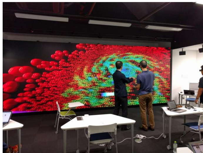
Figure 13 24 面立体表示システムの概要.
