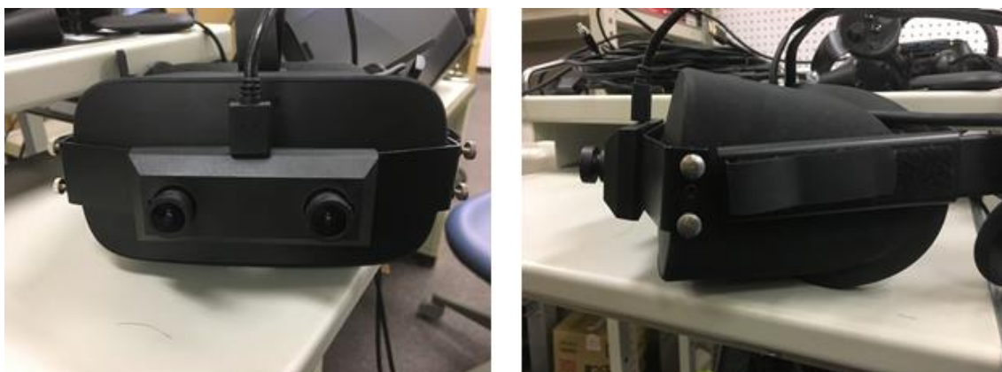
図 5.4-1 ビデオスルー型 Mixed Reality 装置
