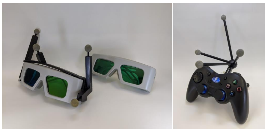
図 8.8-2 BRAVE 用液晶シャッター眼鏡と手持ちコントローラ
