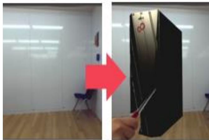
図 8.11-2 AR/MR による製品の設置空間確認の検証のため 原寸のサーバを出現させるアプリを Unity で制作
