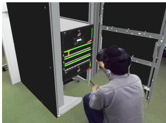
図 8.11-4 CG で表現されたサーバの操作を再現している様子
