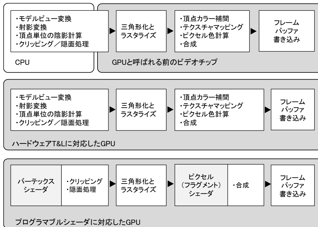
図 2.1.1-1 GPU のグラフィックスパイプラインの変化
