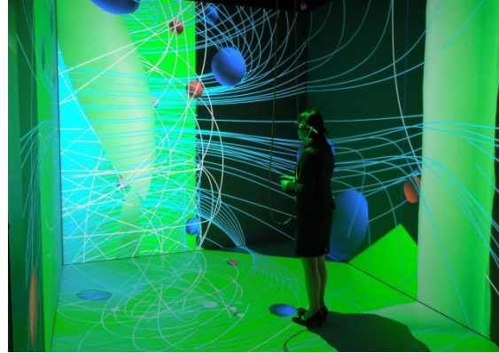
図 8.10-1 CompleXcope による磁力線の再結合のシミュレーション結果の可視化。青線と白線はそれぞれ磁力線とイオンの粒子軌道を、赤球と青球は磁力線の出発点と終点を、緑の面はプラズマ圧力の等値面を表す。
